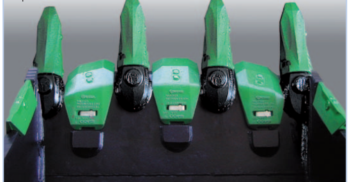
zusätzlicher Verschleißschutz, optional für XHD-Modelle
