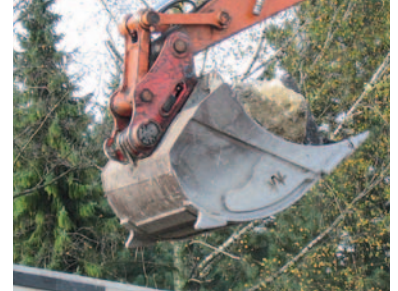
Standard-Zahnsystem Esco Super V, andere Zahnssysteme auf Kundenwunsch
