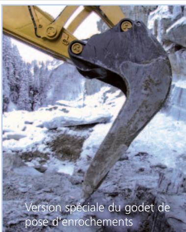
Ensembles de dents Esco Super V standard, autres ensembles de dents sur demande.
