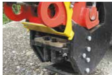
Schwimmend gelagerte Trägerplatte für präzises Kuppeln
