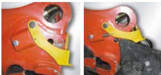
Schutzabdeckung für die Kupplungen öffnet automatisch bei Hydraulikwerkzeugen
