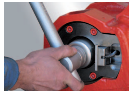
Verriegelungsbolzen mit 1 1/2 Umdrehungen öffnen
