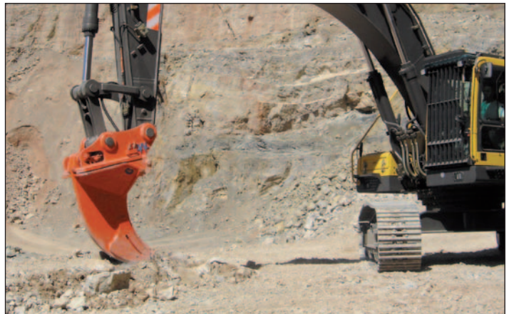
Reißzahn XXHD für extreme Einsatzbedingungen aus WHD 450 Sonderverschleißstahl, wechselbarer Esco Schenkelschutz und Zahn
