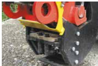
Schwimmend gelagerte Trägerplatte für präzises Kuppeln
