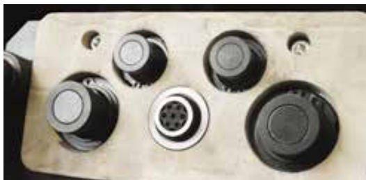
Option Elektroakupplung: Ab OMX 350 ist eine Elektroakupplung vorgesehen
