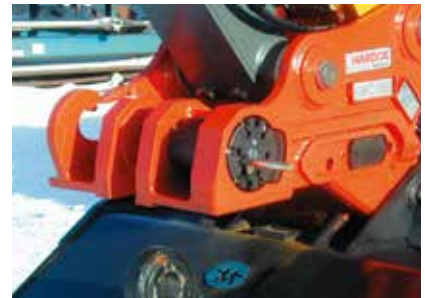
Verriegelungsbolzen mit 1 1/2 Umdrehungen öffnen
