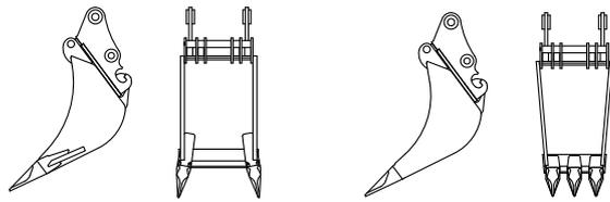
Forme de construction standard pour la propulsion, forme superposante pour travaux de finition
