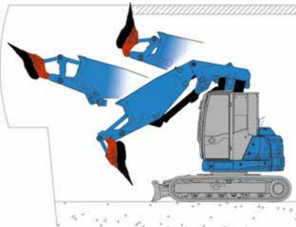
La forme de construction permet les différentes positions de travail
