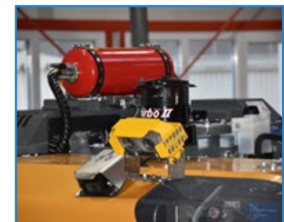
Löschmittelbehälter und optionales Personen- Erkennungssystem Blaxtair
