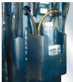
Protection robuste pour la cartouche de graissage
