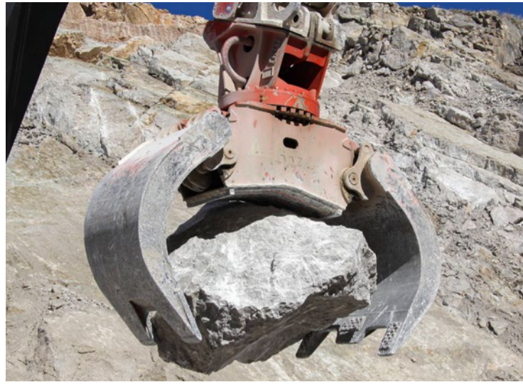
Am Steingreifer Lobster sind die Entwicklungsschritte der Schalenformen über die Jahre deutlich erkennbar
