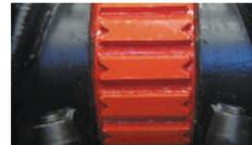
**Hardox-Panzer schützt das Getriebe**
