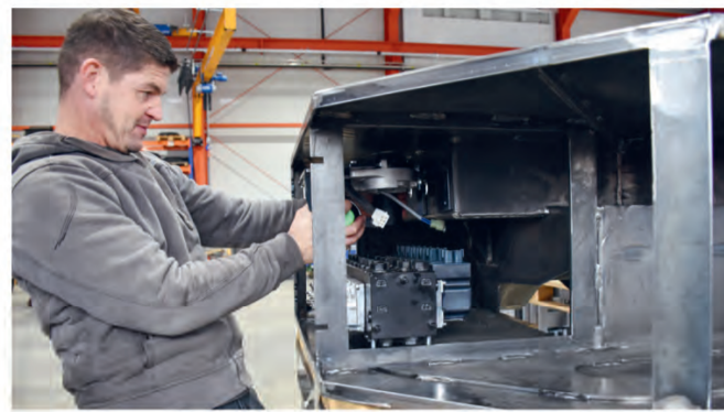
Der neue Steuerkasten wird gerade komplettiert
