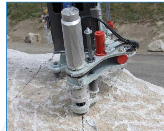
Spaltvorgang mit Zylinder C 12
