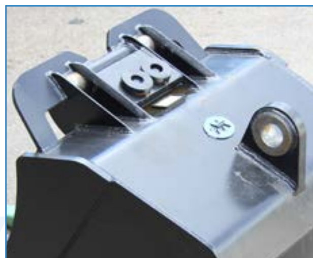
A-Lock 3 Werkzeugaufnahme mit Federkonsole, Verschleißausgleich
