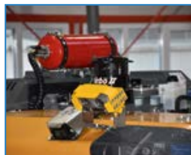
Löschmittelbehälter und optionales Personen-Erkennungssystem Blaxtair
