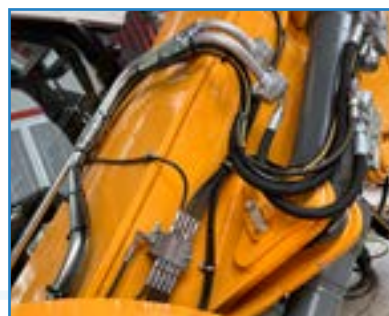
Schmierverteiler der Zentralschmierung
