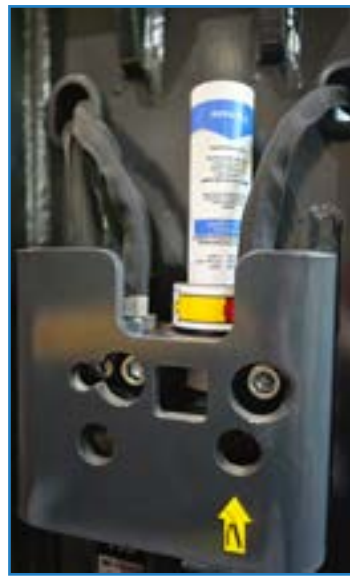
Zentralschmierpumpe - Installation serienmäßig
