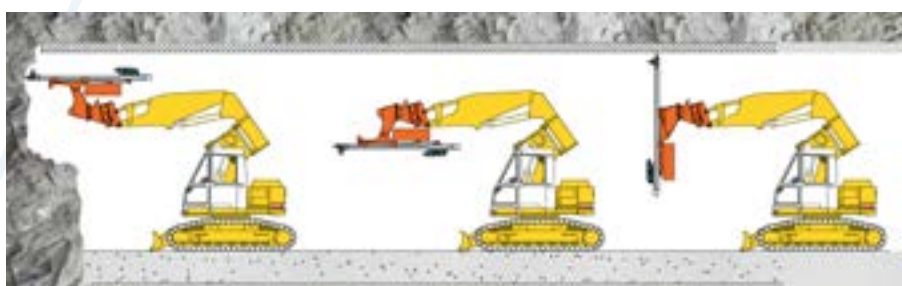
Bewegungsmöglichkeiten Anbaubohranlagen mit der T-Ausführung im Tunnel
