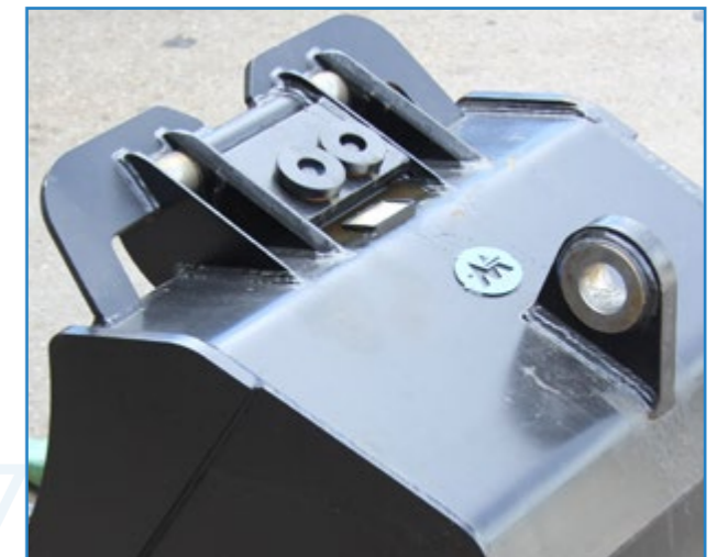
A-Lock 3 Werkzeugaufnahme mit Federkonsole , Verschleißausgleich
